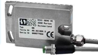
BB kiihtyvyyssanturi Korjaa liikkeen vaikutukset punnitukseen nostettaessa.
